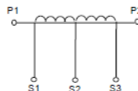
Слика 1 Ознаке прикључака струјних мерних трансформатора
